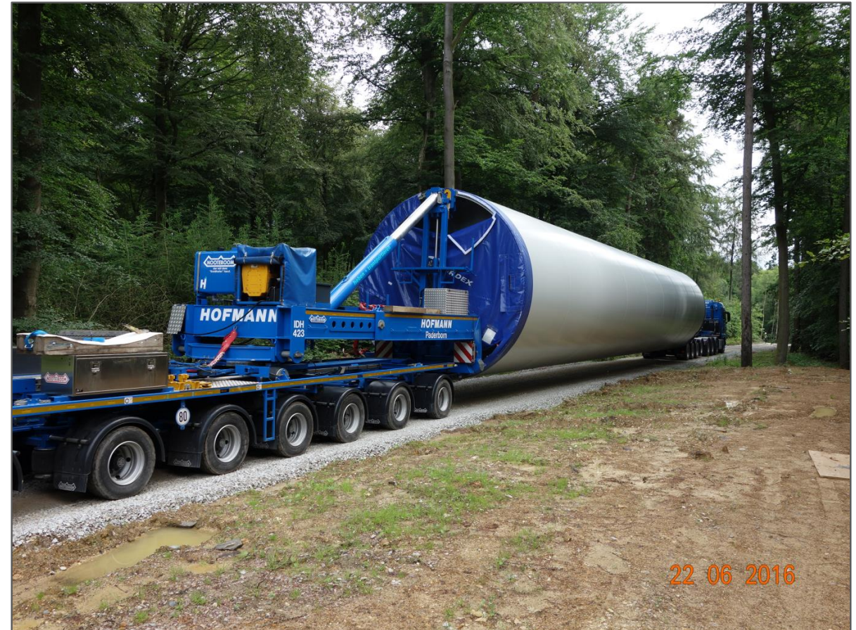
Abb. 15: Anlieferung eines 30 m langen Stahlrohrturms über befestigten Waldweg
